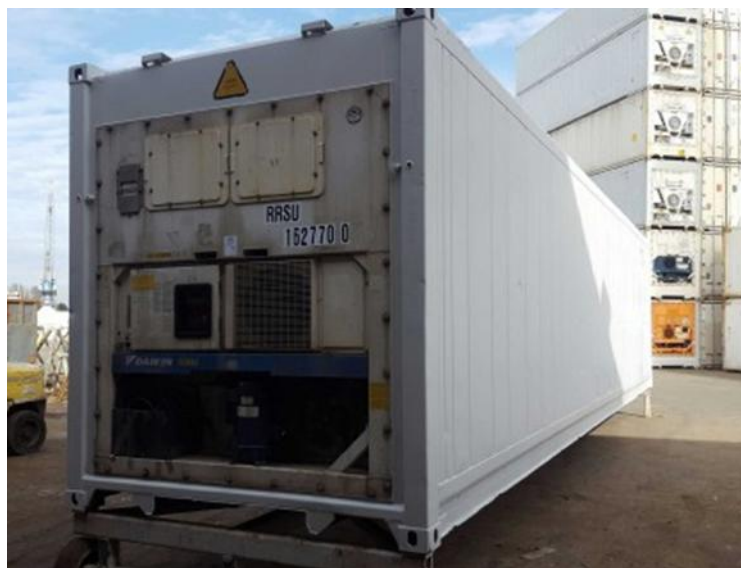
Рис. 10. 20-футовый рефрижераторный контейнер Daikin [13]
