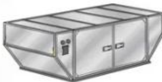
Рис. 7. Рефрижераторный авиационный контейнер LD-29 [10]
